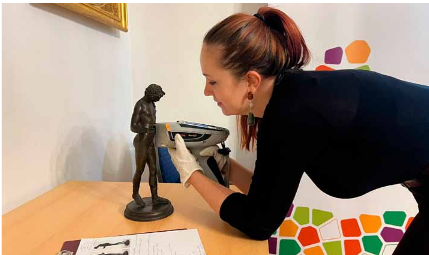
Měření materiálového složení sochy pomocí XRF spektrometru. Foto: archiv autorky
