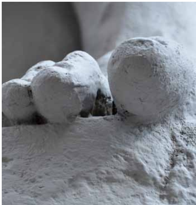
Detail modelace sochařských děl s patrnými obtížně dostupnými místy, kde nátěr nebyl rovnoměrně aplikován, foto © Viktor Kovařík
